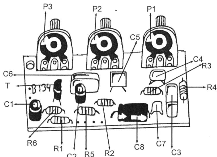
D / Die drei Potentiometer werden direkt auf die Platine gelötet. Um Brummeinstreuungen zu vermeiden, müssen die Anschlußkabel zur Signalquelle (z.B. Plattenspieler) und zum Endverstärker mit abgeschirmten Kabeln verlegt werden. Dabei muß die Abschirmung an den Anschluß mit dem Minuszeichen "-" gelegt werden. Es ist auch empfehlenswert, die Platine in ein abgeschirmtes Gehäuse (Metallgehäuse) zu bauen. Dabei muß das Gehäuse mit Minus "-" verbunden werden.
